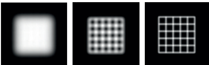
1 Simulation der Auflösungssteigerung mittels Verringerung der Wellenlänge: Abbildung einer Teststruktur bei (a) 1064 nm, (b) 532 nm und (c) 266 nm durch ein abbildungsfehlerfreies optisches System
